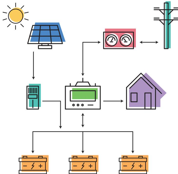
FIGURE 2: PV SYSTEM WITH CHARGE CONTROLLER AND BATTERY INVERTER
